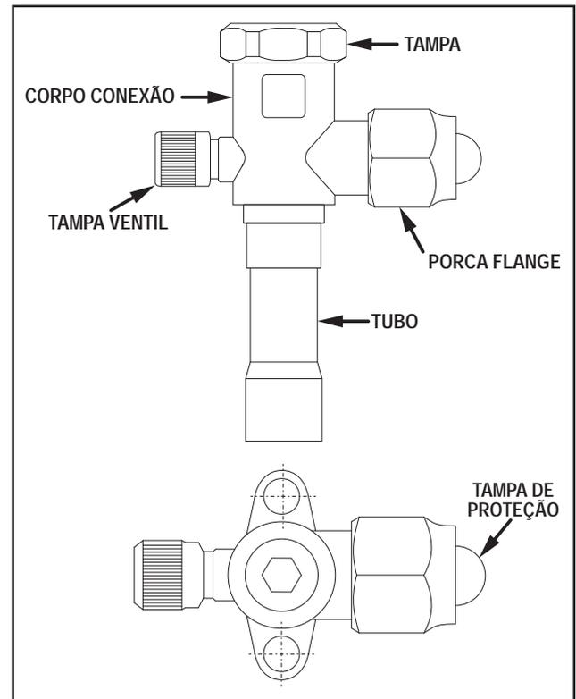
FIG. 24 - VÁLVULA DE SERVIÇO LINHAS SUÇÇÃO/EXPANSÃO
