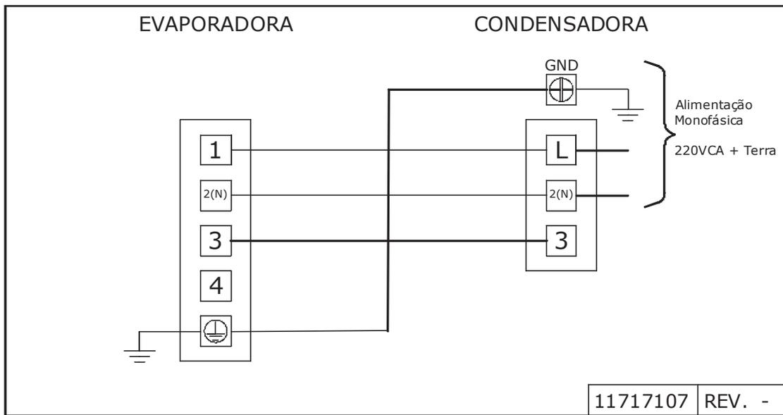
**8.1.2 - Esquemas de Interligação: 42MAQ\_09 / 12 / 18 com 38KQX\_09 / 12 / 18 - Quente/Frio (CR)**
