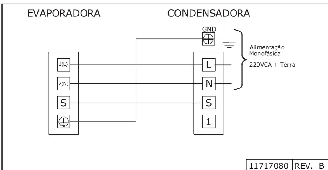
**Fixação do Cabo de Alimentação Elétrica das Unidades Condensadoras**
