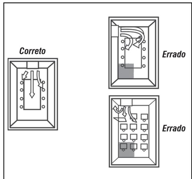
FIG. 12 - POSIÇÃO DA EVAPORADORA NO AMBIENTE
