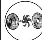
Grades desmontáveis: para facilitar a limpeza das grades e da hélice do seu ventilador Mondial, remova a grade dianteira pressionando as travas de segurança e em seguida puxando a grade para frente. Para remover a hélice, gire o botão em sentido horário e puxe-o para frente.
