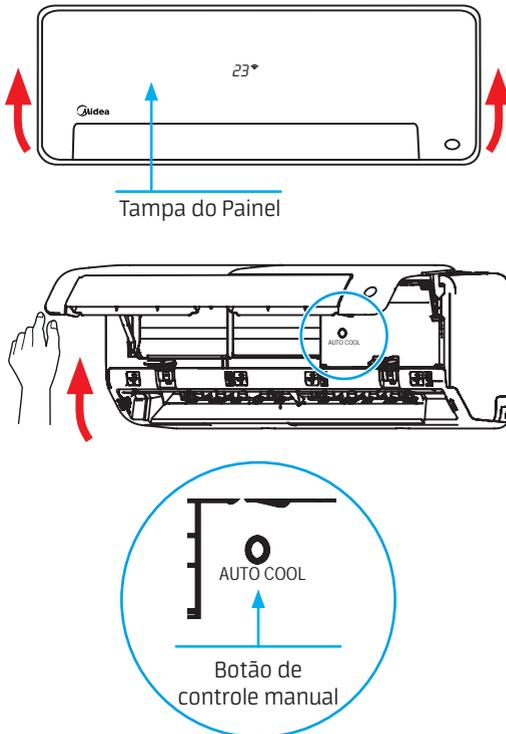
1. Abrir e levantar o painel dianteiro até ficar fixo emitindo o clique de encaixe.
