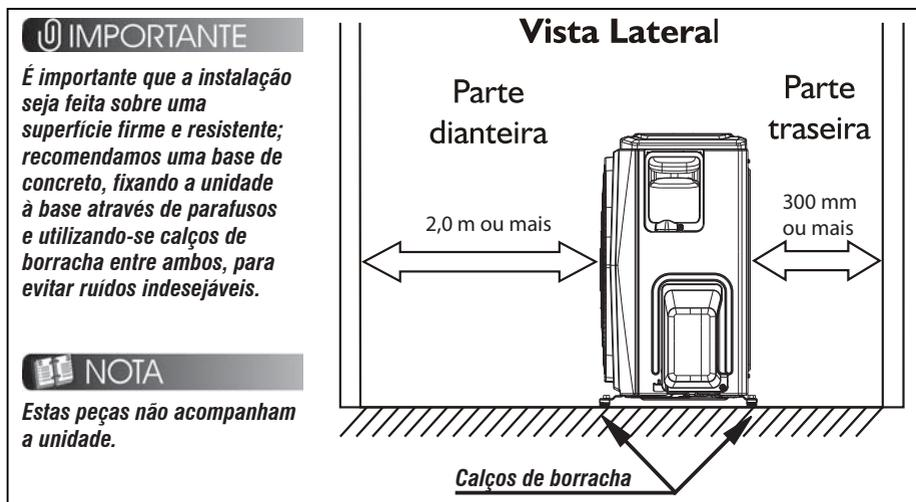
FIG. 3 - ESPAÇAMENTOS E CALÇOS DE BORRACHA
