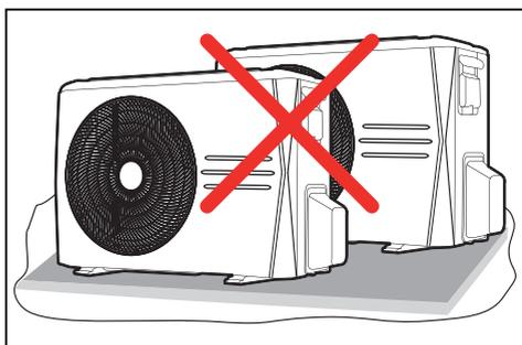
FIG. 1b - EVITAR INSTALAÇÃO EM SEQUÊNCIA
