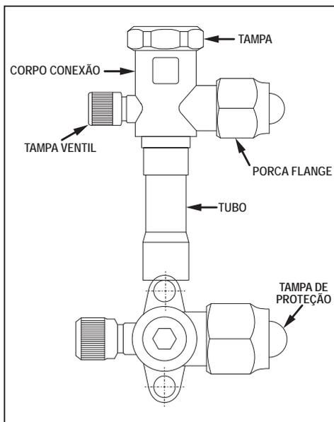
FIG. 17 - VÁLVULA DE SERVIÇO LINHAS SUÇÃO/EXPANSÃO
