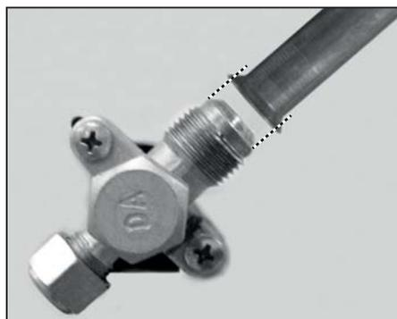
FIG. 23 - CONEXÃO NIPLÉ TUBO
