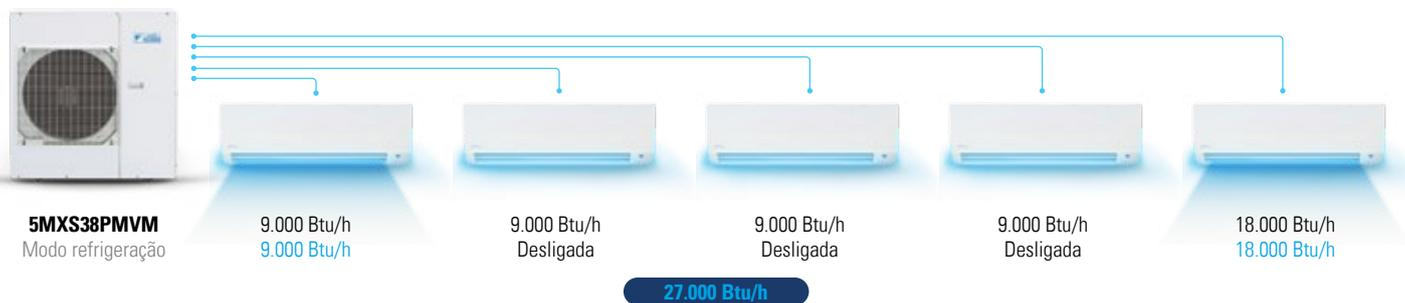
Quando há apenas algumas evaporadoras em funcionamento e outras desligadas, a condensadora entrega a capacidade total das evaporadoras em operação.
